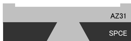
図3. 異種金属の締結 (上: AZ31 下: SPCE)
